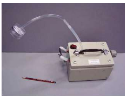
Figure 24- Montage avec filtre et pompe pour échantillonnage de courte durée (10-20min) (d'après Hanhela et al. 18 )
