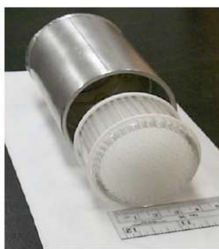
Figure 29- Prototype de l'échantillonneur en verre recouvert de polymère dans son contenant en aluminium (d'après Maddalena et McKone 32 )
